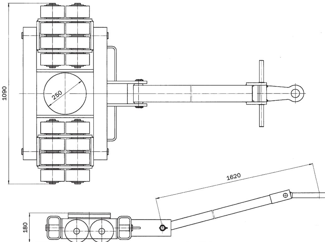
Transportfahrwerk L20, lenkbar
